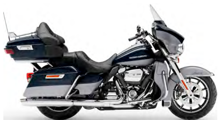
Ultra Limited Low (FLHTKL) Milwaukee-Eight 114, 1868 cm 3 66 kW (90 PS) / 164 Nm, Sechsganggetriebe Techn. Daten: Seite 66
