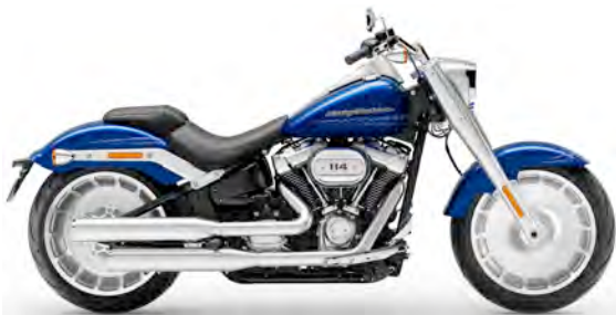
Fat Boy 114 (FLFBS) Milwaukee-Eight 114, 1868 cm 3 69 kW (94 PS) / 155 Nm, Sechsganggetriebe Techn. Daten: Seite 53
