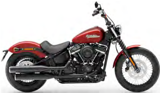
Street Bob (FXBB) Milwaukee-Eight 107, 1745 cm 3 64 kW (87 PS) / 145 Nm, Sechsganggetriebe Techn. Daten: Seite 43
