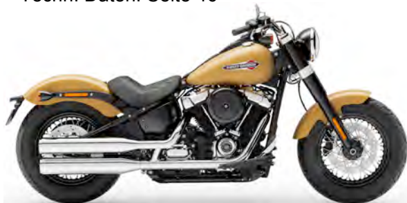
Softail Slim (FLSL) Milwaukee-Eight 107, 1745 cm 3 64 kW (87 PS) / 145 Nm, Sechsganggetriebe Techn. Daten: Seite 48
