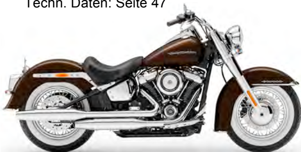
Deluxe (FLDE) Milwaukee-Eight 107, 1745 cm 3 64 kW (87 PS) / 145 Nm, Sechsganggetriebe Techn. Daten: Seite 49
