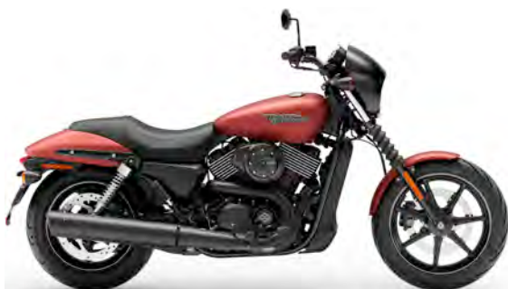
Street (XG 750) Revolution X, 749 cm 3 43 kW (58 PS) / 59 Nm, Sechsganggetriebe Techn. Daten: Seite 33
