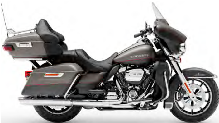
Ultra Limited (FLHTK) Milwaukee-Eight 114, 1868 cm 3 66 kW (90 PS) / 164 Nm, Sechsganggetriebe Techn. Daten: Seite 65
