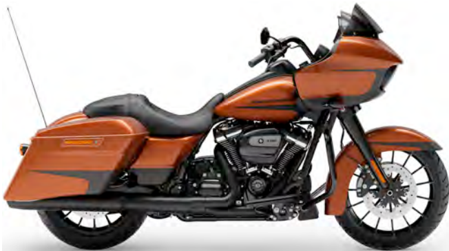
Road Glide Special (FLTRXS) Milwaukee-Eight 114, 1868 cm 3 66 kW (90 PS) / 163 Nm, Sechsganggetriebe Techn. Daten: Seite 63
