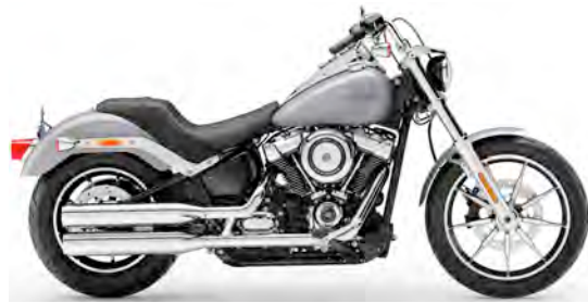
Low Rider (FXLR) Milwaukee-Eight 107, 1745 cm 3 64 kW (87 PS) / 145 Nm, Sechsganggetriebe Techn. Daten: Seite 44
