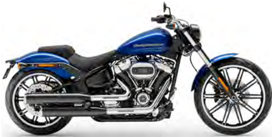
Breakout 114 (FXBRS) Milwaukee-Eight 114, 1868 cm 3 69 kW (94 PS) / 155 Nm, Sechsganggetriebe Techn. Daten: Seite 51
