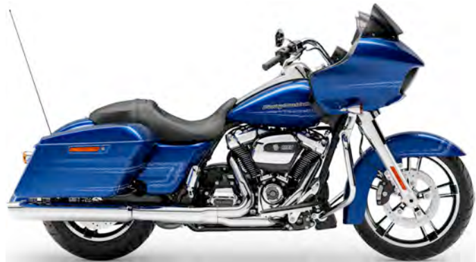
Road Glide (FLTRX) Milwaukee-Eight 107, 1745 cm 3 66 kW (90 PS) / 150 Nm, Sechsganggetriebe Techn. Daten: Seite 62
