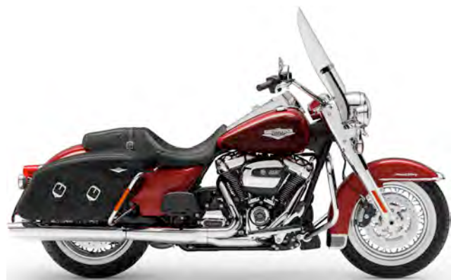
Road King Classic (FLHRC) Milwaukee-Eight 107, 1745 cm 3 66 kW (90 PS) / 150 Nm, Sechsganggetriebe Techn. Daten: Seite 58
