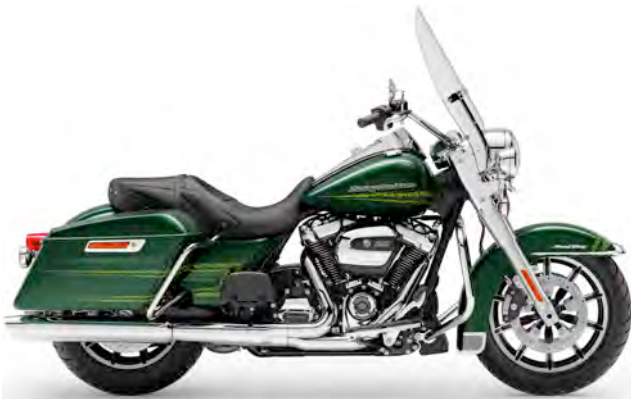
Road King (FLHR) Milwaukee-Eight 107, 1745 cm 3 66 kW (90 PS) / 150 Nm, Sechsganggetriebe Techn. Daten: Seite 57
