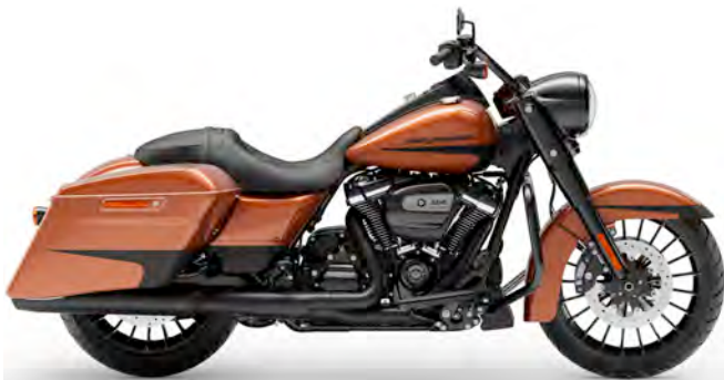
Road King Special (FLHRXS) Milwaukee-Eight 114, 1868 cm 3 66 kW (90 PS) / 163 Nm, Sechsganggetriebe Techn. Daten: Seite 59
