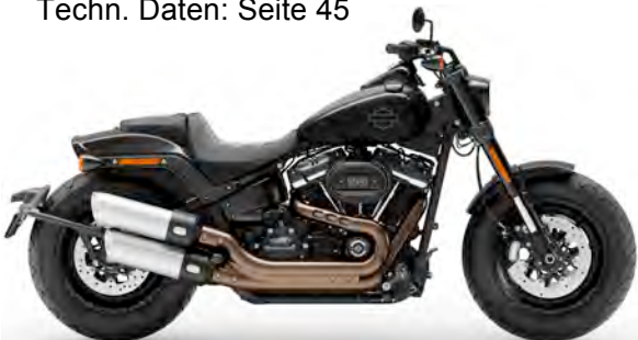
Fat Bob 114 (FXFBS) Milwaukee-Eight 114, 1868 cm 3 69 kW (94 PS) / 155 Nm, Sechsganggetriebe Techn. Daten: Seite 47
