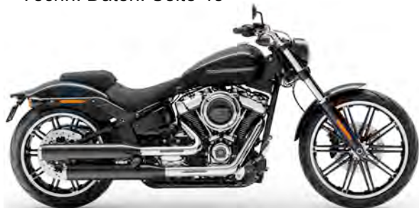
Breakout (FXBR) Milwaukee-Eight 107, 1745 cm 3 64 kW (87 PS) / 145 Nm, Sechsganggetriebe Techn. Daten: Seite 50
