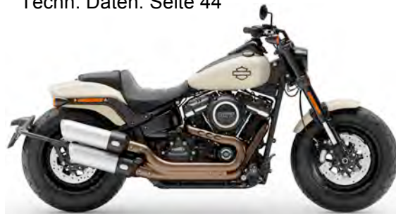
Fat Bob (FXFB) Milwaukee-Eight 107, 1745 cm 3 64 kW (87 PS) / 145 Nm, Sechsganggetriebe Techn. Daten: Seite 46
