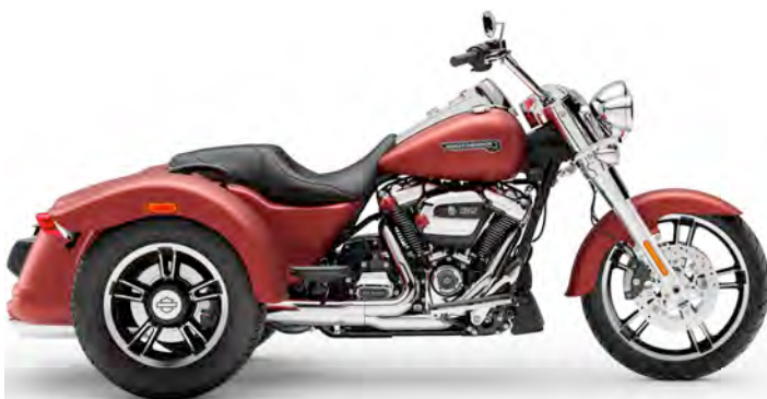
Freewheeler (FLRT) Milwaukee-Eight 114, 1868 cm 3 65 kW (88 PS) / 162 Nm, Sechsganggetriebe Techn. Daten: Seite 67
